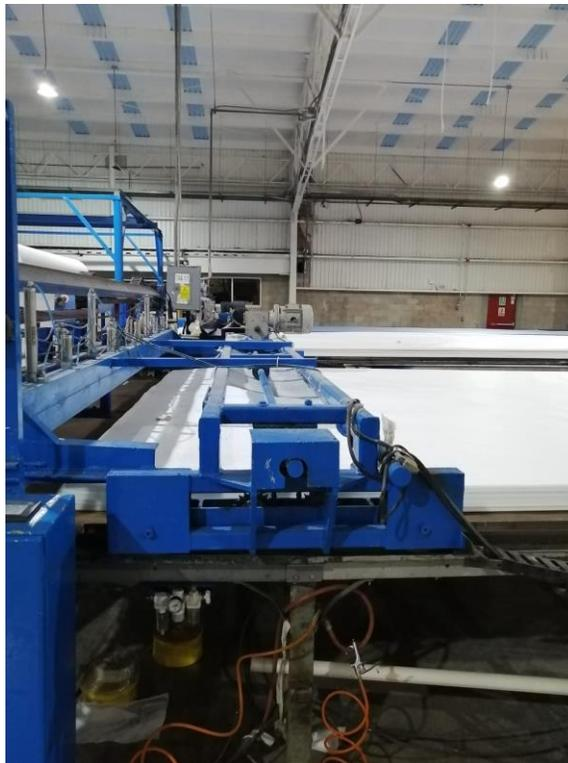
Figura No. 3 Sujetador de Tendido
